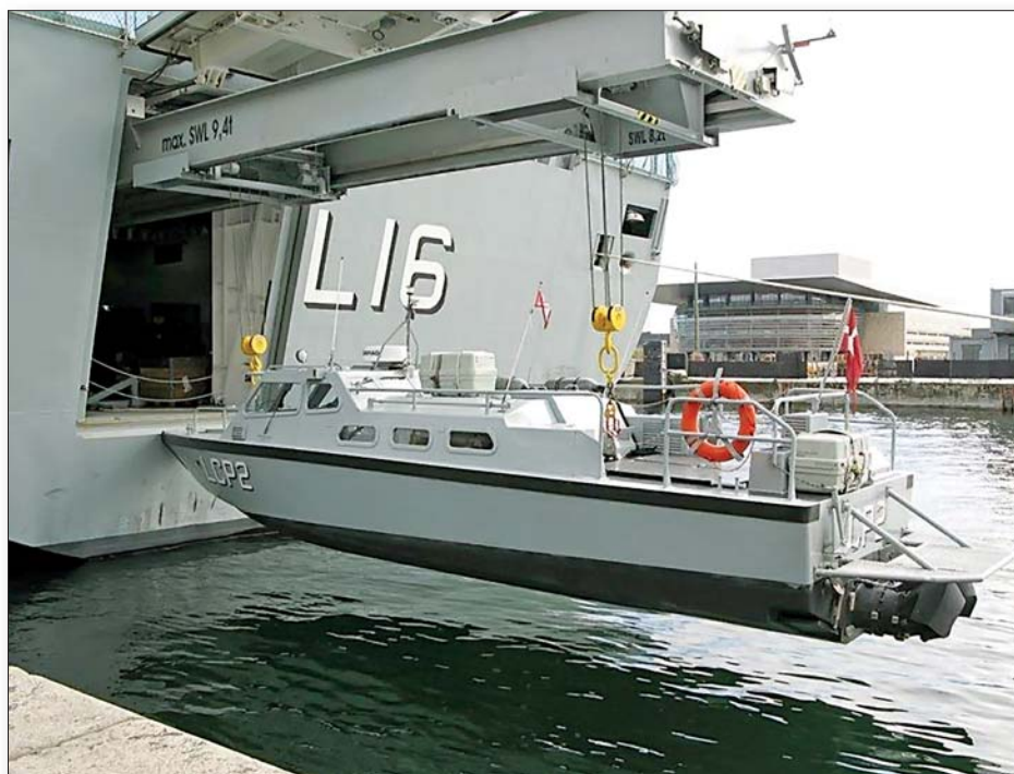
Кран избације и спушта у воду десантни чамца Storebro SB90E
