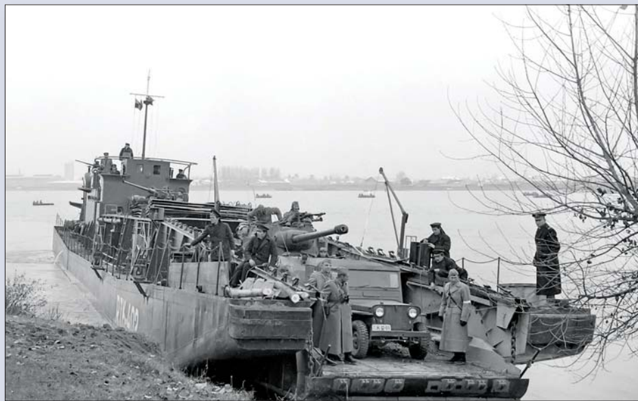
Шабач 1954. године – РТК-402 искрцава десант. Брод је наоружан по првој конфигурацији са ПАТ 40 mm и два ПАМ 12,7 милиметара
